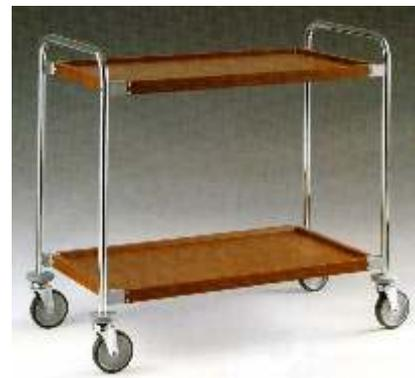
Struttura in tubo tondo di acciaio cromato, piani in lamiera di acciaio ricoperti con pellicola simil legno. Giunti angolari in pressofusione di alluminio. Paracolpi in gomma.
