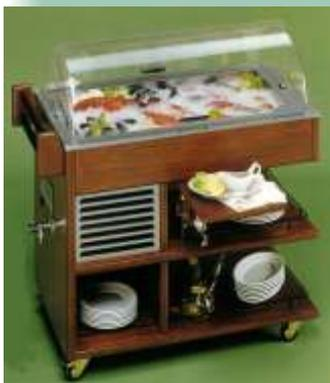
Espositore refrigerato per pesce. Vasca in Acciaio Inox AISI 316 resistente alla corrosione salina. Evaporatore annegato nel poliuretano della vasca. Struttura portante in legno colore noce scuro, chiaro o bianco laccato. Altezza vasca mm. 110 Cupola superiore in policarbonato trasparente semicilindrica h mm. 252.
